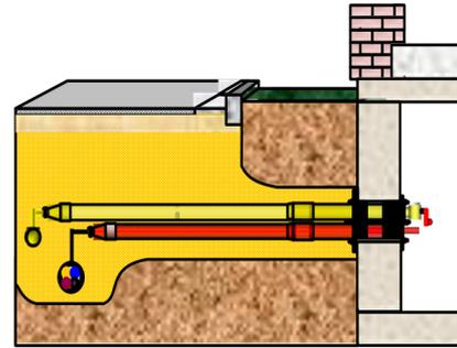
Abbildung 6: Mehrspartengebäudeeinführung für Gebäude mit Keller (2/4 Medien)
