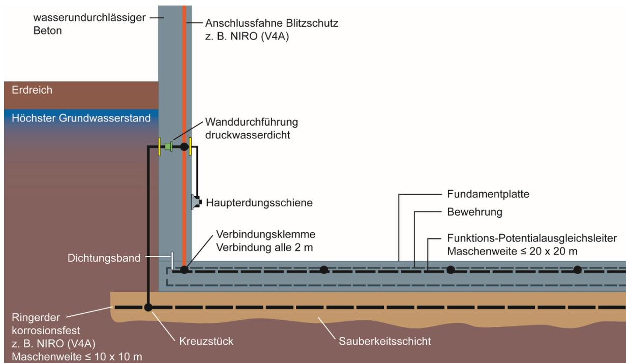
Abbildung 9: Anordnung des Erders bei „weißer Wanne“ aus wasserundurchlässigem Beton;
