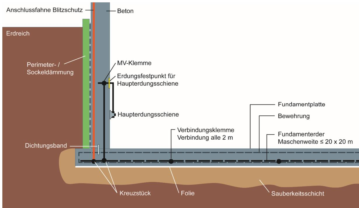
Abbildung 8: Anordnung des Fundamenterders bei geschlossener Bodenplatte (Kellerwand gedämmt);
