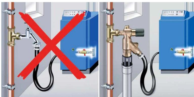
Trinkwasser-Installationen dürfen nicht unmittelbar mit Nicht-Trinkwasseranlagen (z. B. Heizungsanlage) verbunden werden, damit keine schädlichen Einflüsse auf die Trinkwasserqualität entstehen.
